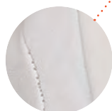
Cosido con hilo para-aramida (Kevlar®)
